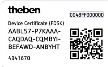
L'ETS produit, après la saisie de la FDSK, une clé outil spécifique à chaque appareil. Par le bus, l'ETS envoie la clé outil vers l'appareil devant être configuré. La transmission est codée et authentifiée au moyen de la clé FDSK d'origine ou de celle qui a été précédemment saisie. Ni la clé outil, ni la clé FDSK ne sont envoyées en texte en clair par le bus.
