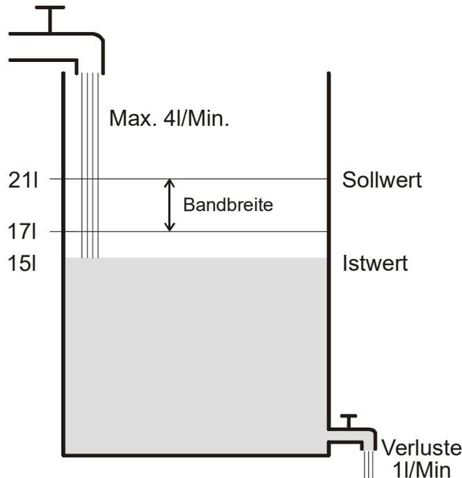
Si la quantité de remplissage est de 15 l, on obtient un écart de réglage de 21 l – 15 l = 6 l. Comme notre valeur réelle se situe en dehors de la largeur de bande, le régulateur va commander le débit à 100 %, soit 4 l/minute.
