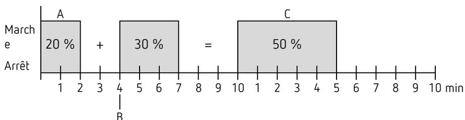
**i** Si, au moment de la réception de la nouvelle grandeur de réglage, la nouvelle durée d'activation de consigne est déjà dépassée pour le cycle en cours, la sortie est immédiatement arrêtée et la nouvelle grandeur de réglage est exécutée au cycle suivant.
