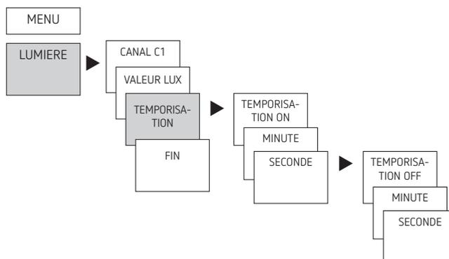
① La temporisation d'enclenchement/déclenchement de **1 min.** est prédéfinie pour éviter les commutations accidentelles notamment dues à l'éclair ou aux phares des voitures. Pendant que la temporisation s'écoule, l'état du canal ON/OFF clignote.
