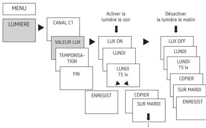
① L'appareil est pré-réglé sur une valeur de 15 lx pour le seuil d'enclenchement et de déclenchement
