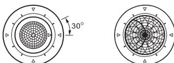
La tête peut être déplacée verticalement de 30° vers le bas. Différentes zones de détection peuvent être obtenues en fonction du réglage (0 °C à 30 °C en 5 réglages).
