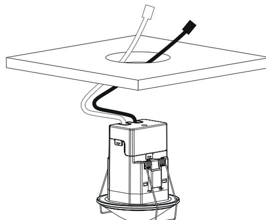
Montage dans les faux-plafonds d'une épaisseur comprise entre 0,5 mm et 3 cm. Le diamètre de la découpe au plafond doit être compris entre 62 mm et 70 mm.
