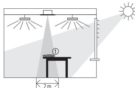
$$\text{Facteur de correction de pièce} = \frac{\text{Valeur de luminosité au niveau du plafond}}{\text{Valeur de luminosité au niveau de la surface de travail}}$$
